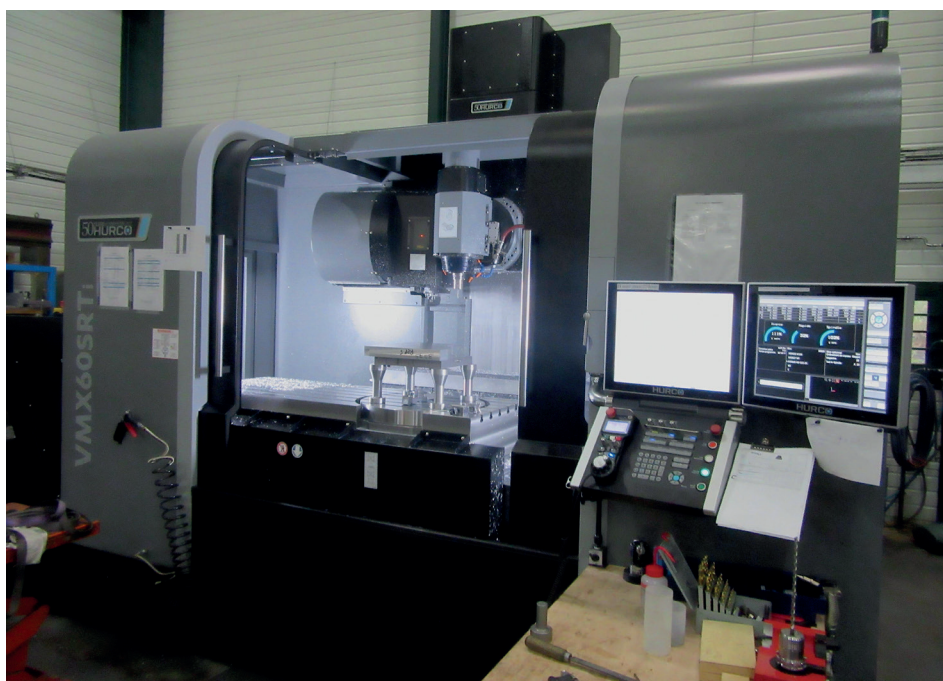
› L'essentiel du parc machines est constitué de centres d'usinage Hurco ; ici, un centre VMX 60 SRTI
